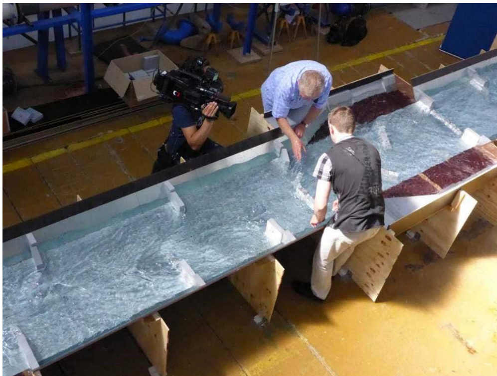
Obrázek: fyzikální model v laboratoři v průběhu návrhu (dostupné z: https://www.horydoly.cz/vodaci/model-slalomoveho-kanalu-pro-rio-by-l-postaven-v-praze.html )
