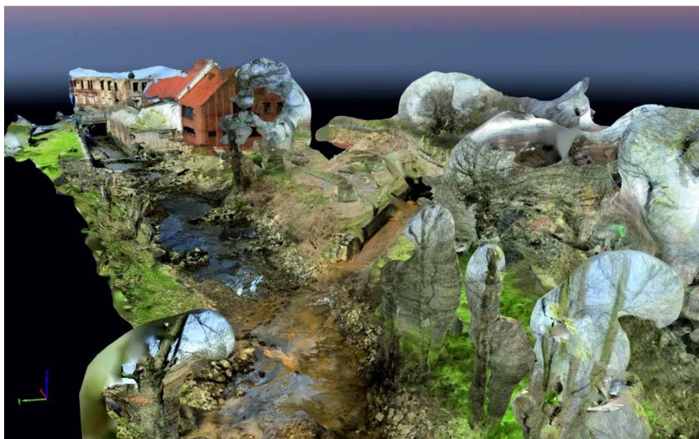
Obrázek: Bodové mračno zaměření pomocí fotogrammetrie (z podkladů pro projekt Kadaň)
